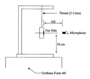
1 METER FROM MICROPHONE TO FAN INTAKE
