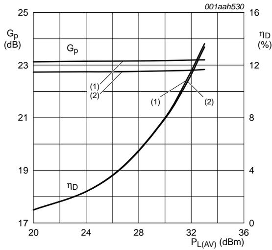
$V_{DS} = 28\text{ V}$ ;  $I_{Dq} = 350\text{ mA}$ ;  $f_1 = 952.5\text{ MHz}$ ;
