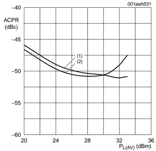
$V_{DS} = 28\text{ V}$ ;  $I_{Dq} = 350\text{ mA}$ ;  $f_1 = 952.5\text{ MHz}$ ;
