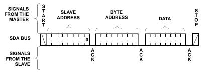
FIGURE 5. BYTE WRITE SEQUENCE
