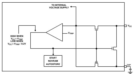
FIGURE 1. CAPACITOR BACK-UP CIRCUIT
