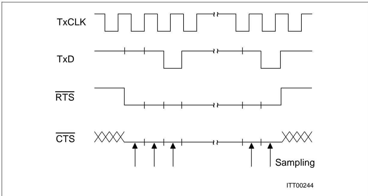
**Figure 35**  $\overline{\text{RTS}}/\overline{\text{CTS}}$  Handshaking
