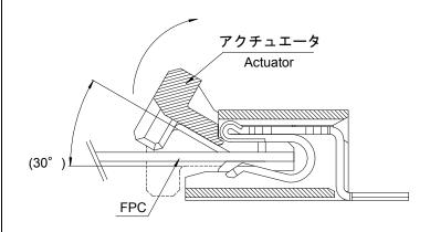
円滑にFPCを挿入する為に、左図の様に約30度の角度にアクチュエータを回転させた 状態でFPCを挿入して下さい。アクチュエータの開き方が不完全ですと、FPCがスムーズに挿入出来なくなります。
