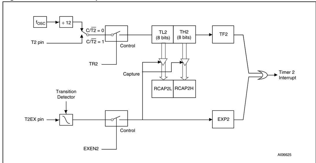
Figure 25. Timer 2 in Auto-Reload mode
