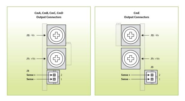
J1 & J2 DC Output Terminals J3 Sense Connector J3 Mating Connector
