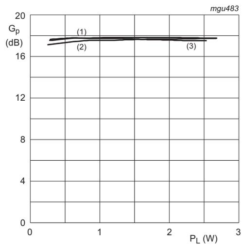
$T_h = 25\text{ }^\circ\text{C}$ ;  $V_{DS} = 36\text{ V}$ ;  $I_{DQ} = 50\text{ mA}$ ; class-AB;  $t_p = 50\text{ }\mu\text{s}$ ;  $\delta = 2\%$ .
