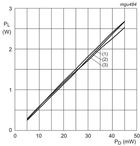
$T_h = 25\text{ }^\circ\text{C}$ ;  $V_{DS} = 36\text{ V}$ ;  $I_{DQ} = 50\text{ mA}$ ; class-AB;  $t_p = 50\text{ }\mu\text{s}$ ;  $\delta = 2\%$ .
